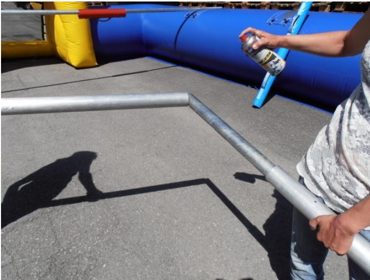
3 teilige Stangen auseinanderziehen und einrasten lassen, zu zweit auf die Umrandung legen Evtl. etwas einsprühen
